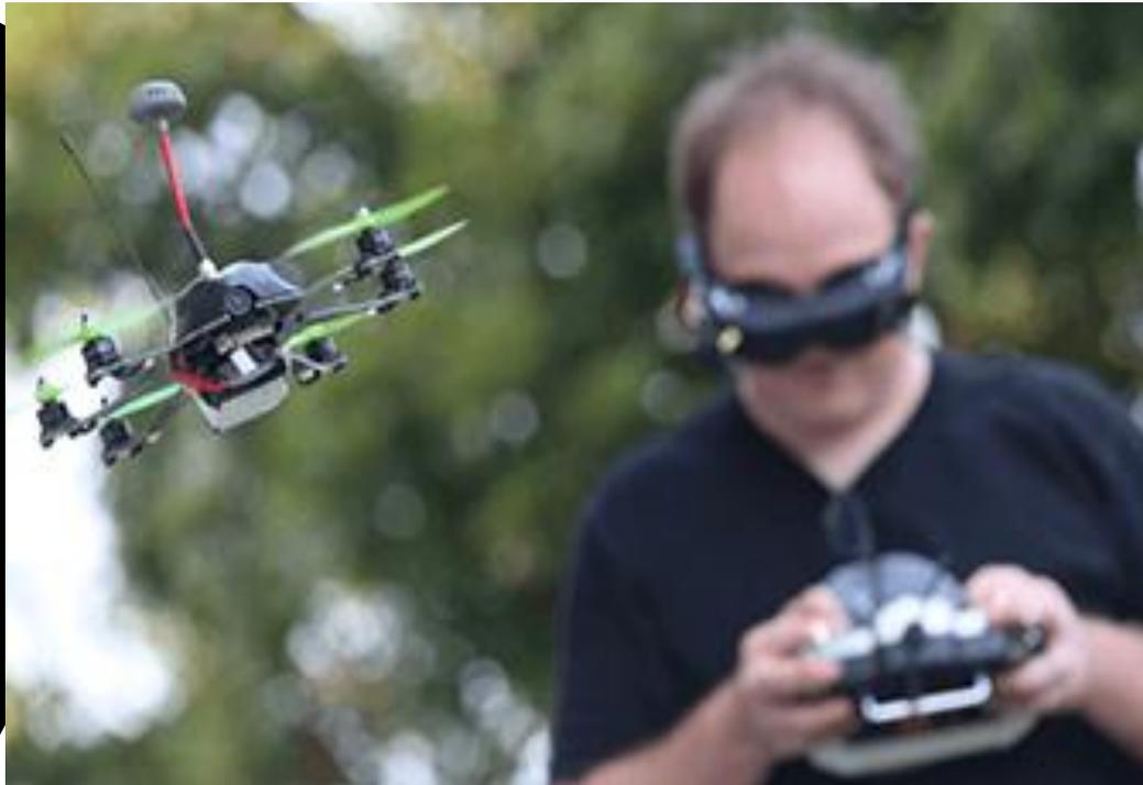
Un pilote amateur, ses lunettes FPV, sa radiocommande et son drone doté d'une caméra à l'avant.
